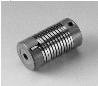
Simpla-Miniflex Wellenkupplungen sind, wie auch die Simplaflex Wellenkupplungen, nicht schaltbare, schlupffreie Wellenkupplungen zum Ausgleich von Fluchtungenauigkeiten beim Verbinden zweier Wellen. Ihr einfacher Aufbau und ihre rostbeständige Ganzmetallbauweise ist ganz auf den Einsatz an kleinen Geräten aller Art zugeschnitten.
